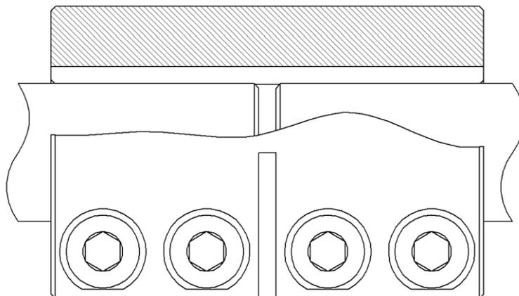
Die **starre Wellenkupplung KBST** ist eine reibschlüssige, lösbare Welle-Welle-Verbindung für zylindrische Wellen mit und ohne Passfeder.
