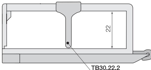
**Innenaufteilung twisterband** - Trennsteg werden nur unmontiert geliefert.
