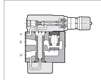
Le valvole tipo Z\*-P sono usate quando nei circuiti oleodinamici si vuole avere un ramo a pressione inferiore a quella principale.
