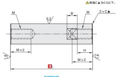
PCPWS 两端内螺纹带扳手槽型
