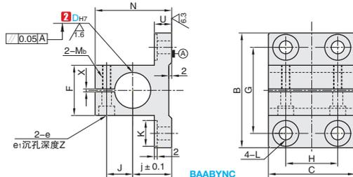
侧面安装沉孔型无定位型
