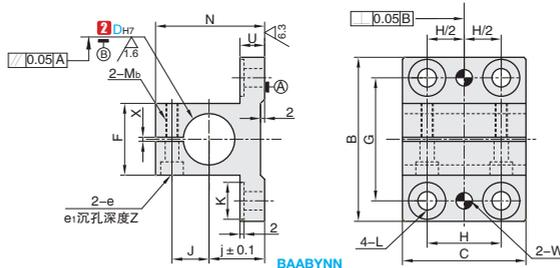
侧面安装沉孔型带定位孔型
