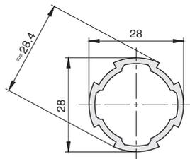
■ 产品特点：通用性标准精益管型材，兼顾功能性和强度，是应用于主体结构的基础产品。
